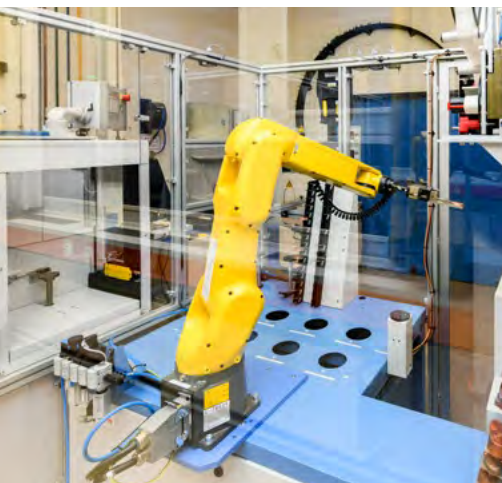
Dieser Roboter analysiert vollautomatisch Stanzproben.
